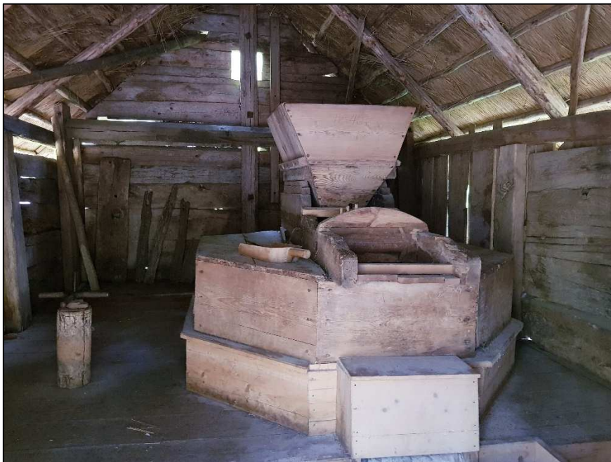
Fig. 33 – Löparen och liggaren återfinns i träkonstruktionen. I förgrunden mjöllådan där det malda spannmålet uppsamlades. En kvarn av denna typ kunde mala cirka 600 kilo spannmål på en arbetsdag. (foto: Carl Persson)
